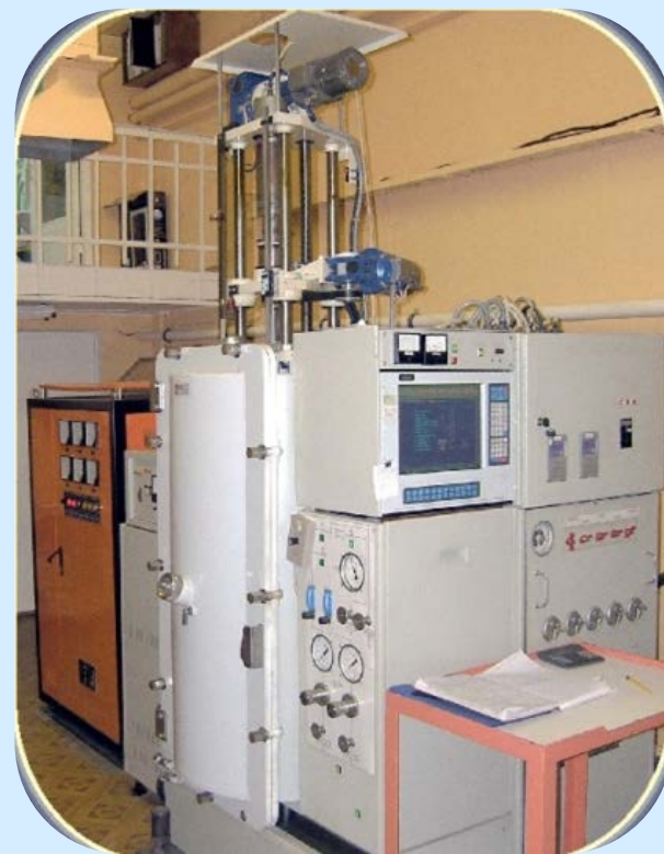
Установка для выращивания монокристаллов методом Чохральского
