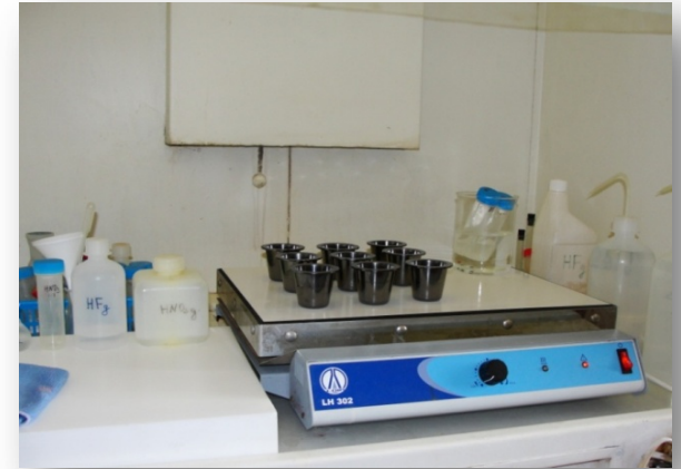
Открытое кислотное вскрытие проб в стеклоуглеродных тиглях СУ-2000
