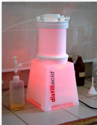
Система дистилляции кислот BERGHOF (инфракрасная лампа) HF, HNO 3
